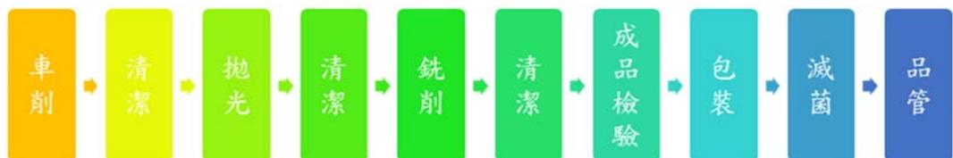
(2)人工水晶體植入系統生產製程如下：
